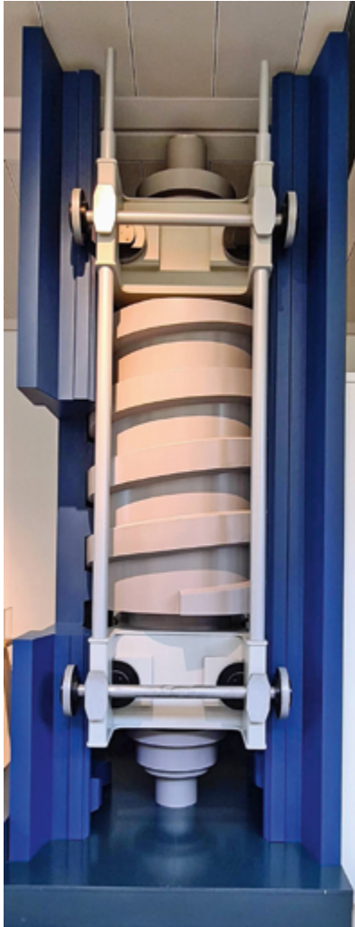
Modell einer Mutterbackensäule im Informationszentrum Niederfinow
