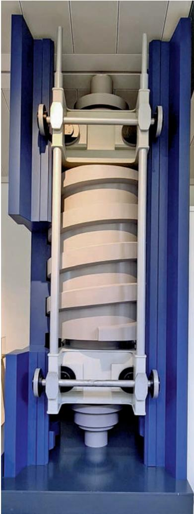
Mutterbackensäulen wurden erstmals beim alten Schiffshebewerk zur Trog-sicherung eingesetzt.
